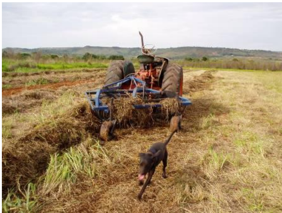
Foto 2 – Enleiradora de palhada, marca IMEP.
