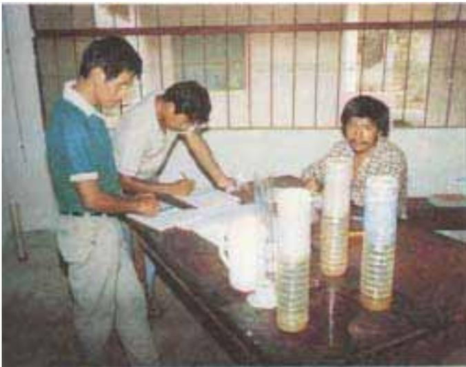
Demostración de capacidad de absorción de agua en diferentes tipos de suelo.
