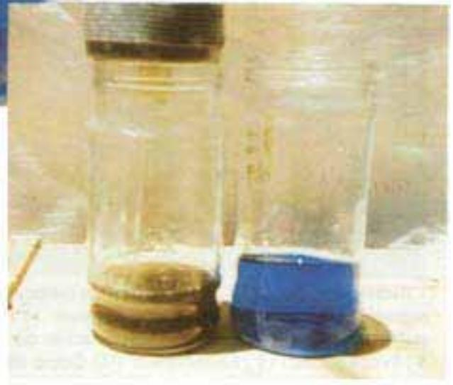
Demostración de la función de la materia orgánica como "serrador" de nutrientes mediante agua teñida con azul de metileno.
